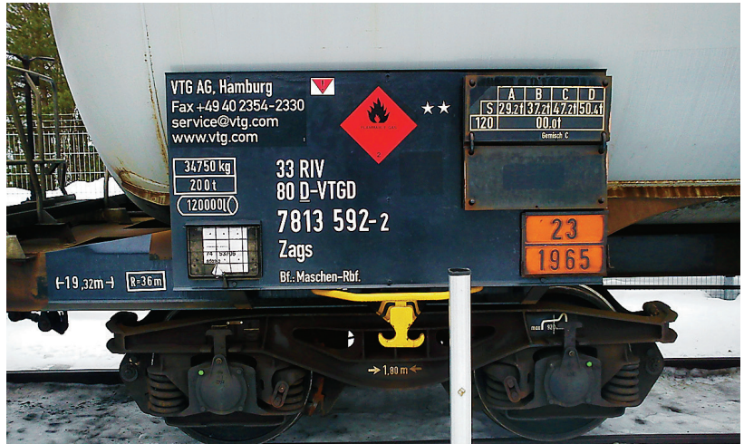
Exempel på märkning av järnvägstankvagn.
